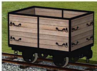
Für die Deutsche Heeresfeldbahn wurden die leichten Feldbahnwagen der alten Bauart auf Unterwagen mit 900mm Achsstand (ungebremst) und 1100 mm Achsstand (gebremst) aufgebaut. Wie lange Wagen dieser Bauart tatsächlich eingesetzt wurden ist nicht bekannt. Mindestens 4 Unterwagen existieren noch, allerdings nur als Flachwagen.
